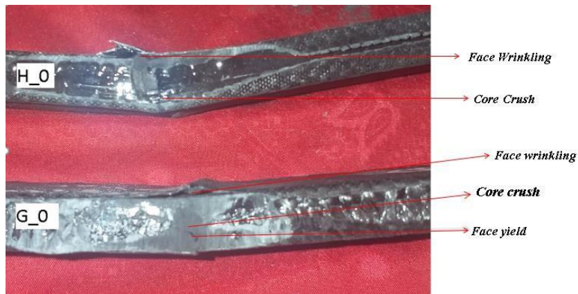
Gambar 4.3 Spesimen Komposit Sandwich Orientasi Printing 0°
