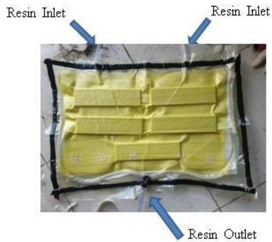
Gambar 3.29 Memasukan Semua Bahan Kedalam Vacuum Bag
