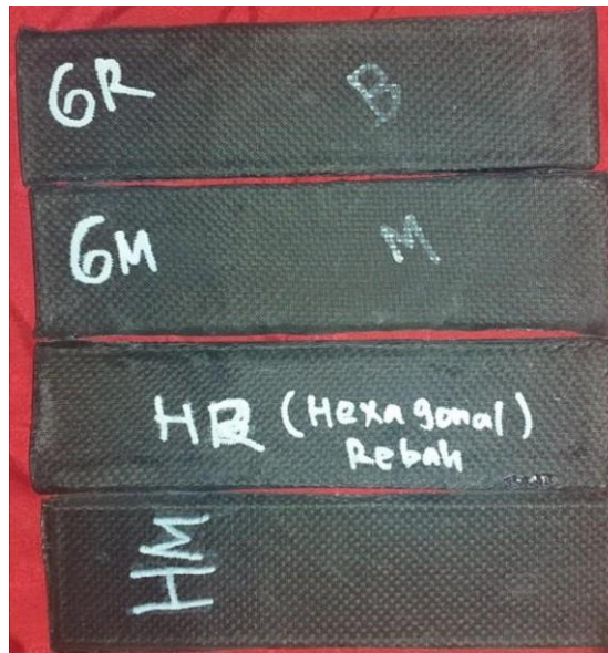
Gambar 3.32 Hasil Core PLA Setelah Vacuum Infusion
