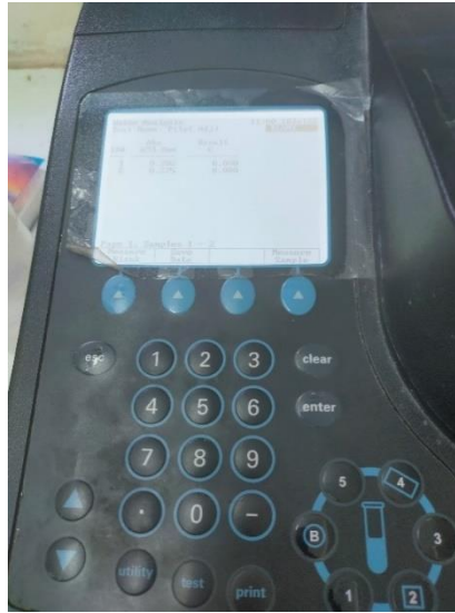
Pengujian analisis kadar fosfor (P) menggunakan UV-VIS di Laboratorium Teknik Lingkungan Sumber : Dokumentasi pribadi,2022
