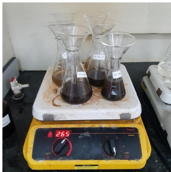
Sampel yang telah di timbang dan ditambahkan kimia kemudian di proses destruksi dalam prosedur pengujian kalium Sumber : Dokumentasi pribadi,2022
