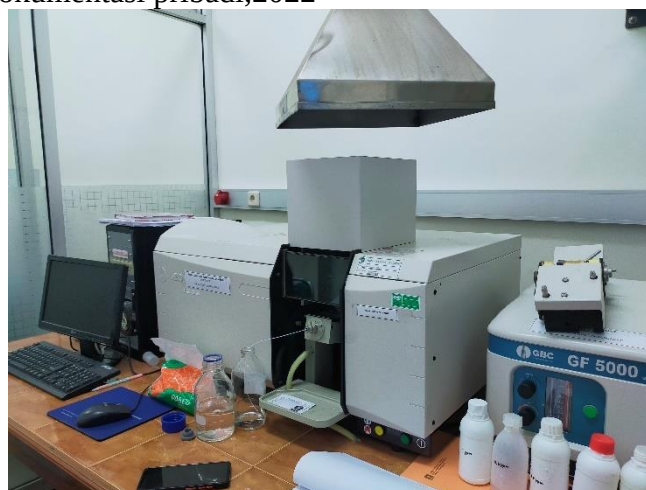
Pengukuran analisis kadar kalium (K) dengan menggunakan Sprektotofotometer Serapan Atom (SSA). Sumber : Dokumentasi pribadi,2022
