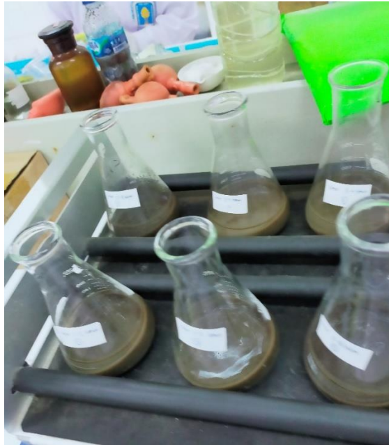
Penggunaan electronic shaker prosedur dalam pengujian fosfor untuk menghomogenkan laurtan sampel timbunan sampah Sumber : Dokumentasi pribadi,2022
