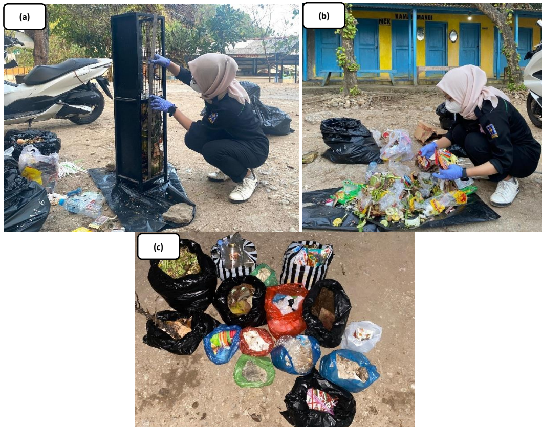
Gambar 4. 12 (a) Pengukuran Volume Menggunakan Sampling Box; (b) Proses Pemilahan Komposisi Sampah; (c) Komposisi Sampah Pantai Sepanjang
