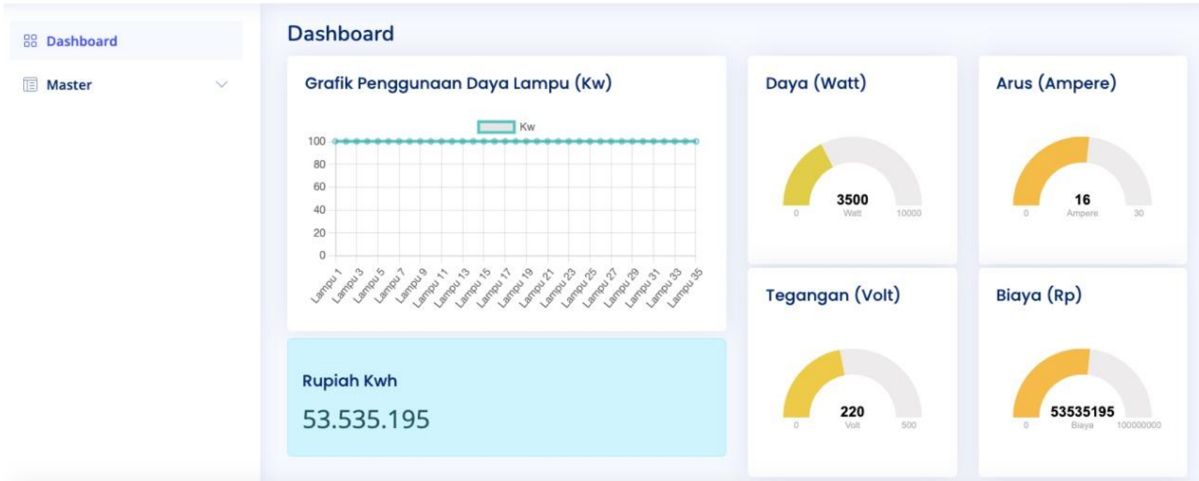
Gambar 4.3 Tampilan Pada Website Sistem Monitoring PJU Brebes Grafik Daya Lampu, Arus, Tegangan, Biaya
