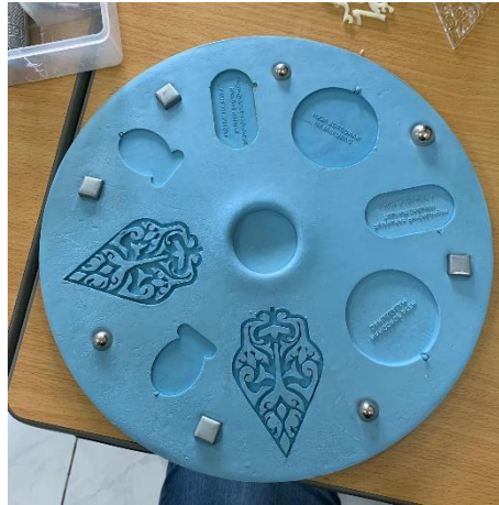
Gambar 4. 11 Rubber Mold setelah di vulkanisir
