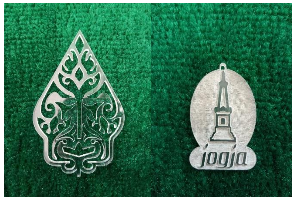
Gambar 3. 23 Master Bahan Akrilik pemesinan laser cutting
