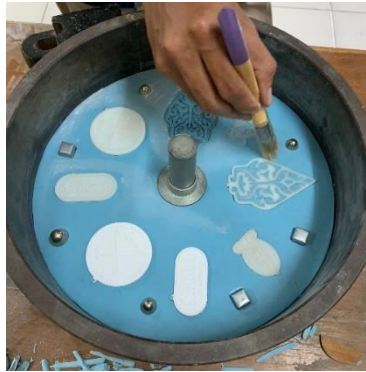
Gambar 3. 27 Memasang Pin Pengunci dan Memberikan Talc
