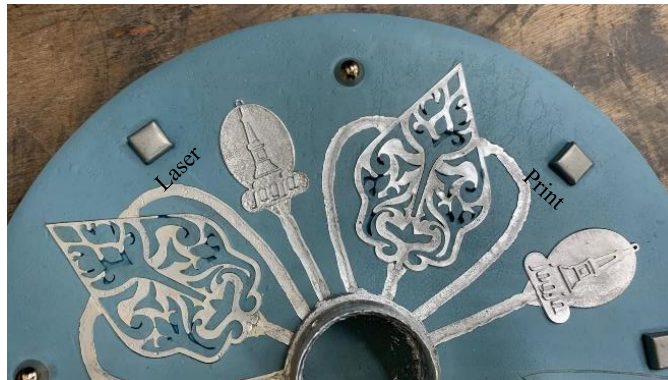
Gambar 4. 12 Hasil Percobaan Spin Casting dengan Parameter acuan
