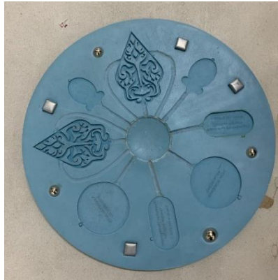
Gambar 3. 31 Hasil Cetakan Setelah Finishing dan Runner ingate
