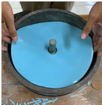
Gambar 3. 28 Memasang Silicone Rubber Bagian Atas
