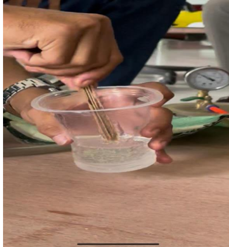
Gambar 3-39 Proses Pencampuran Resin dan Katalis
