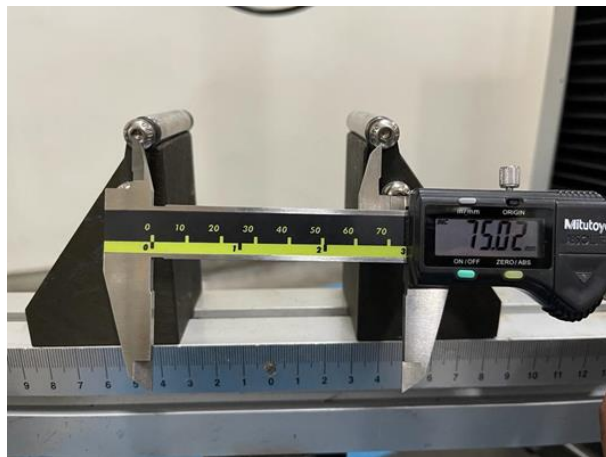
Gambar 3-41 Proses Penentuan Jarak Tumpu Pengujian Bending
