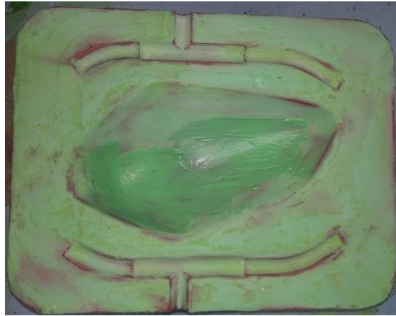
Gambar 4-4 Proses finishing menggunakan dempul
