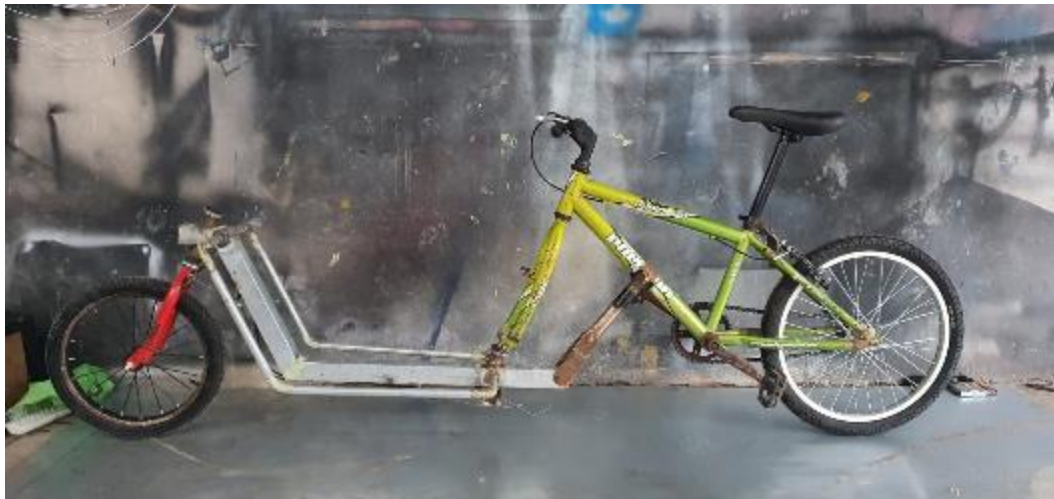
Gambar 4. 25 Loader Kargo Disambungkan dengan Primary Frame
