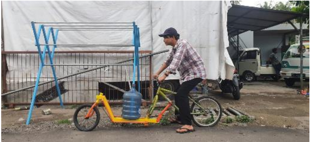
Gambar 4. 35 Pengujian Beban dengan Frame 1
