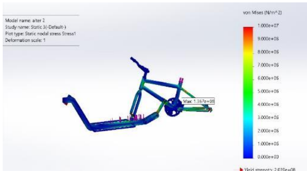
Gambar 4. 9 Hasil Tegangan Von Misses . (137 MPa)
