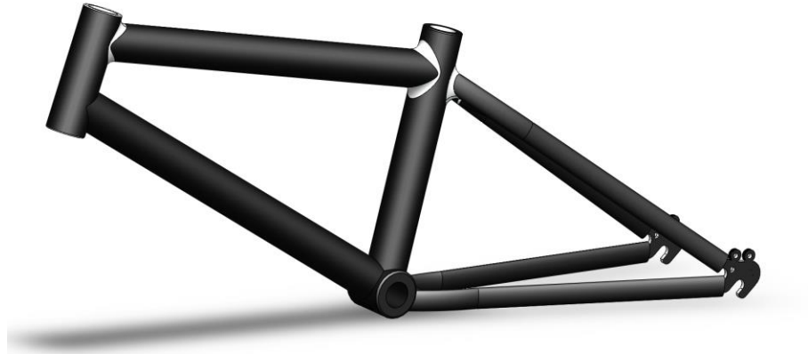
Gambar 4. 7 Frame Sepeda yang Digunakan Sebagai Penelitian
