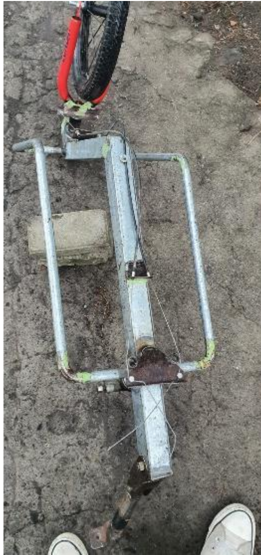
Gambar 4. 29 Penggunaan Wire pada Steering
