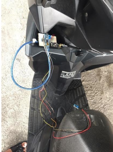
Gambar 4.5 Pemasangan transmitter pada tempat duduk sepeda motor
