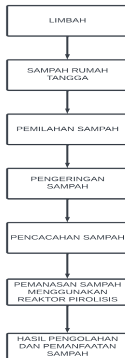
Gambar 4.34 Contoh desain pengolahan sampah metode pirolisis
