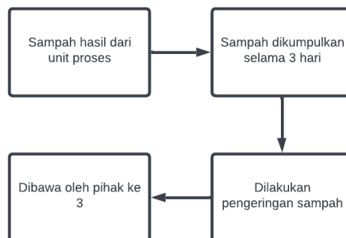
Gambar 4.33 Proses pengolahan sampah sementara di Ipal Balai Pialam
