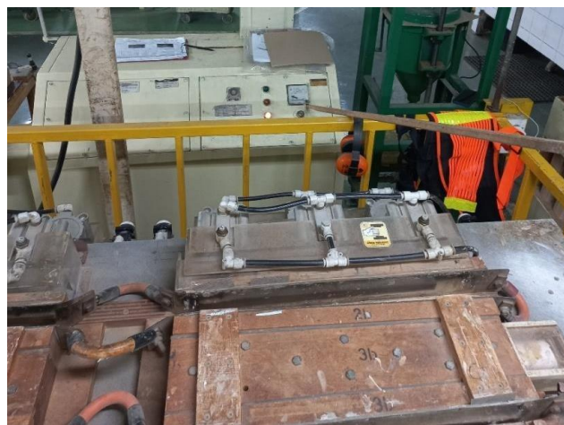
Gambar 5.4 Tombol On/Off Mesin Rotary yang terlalu jauh
