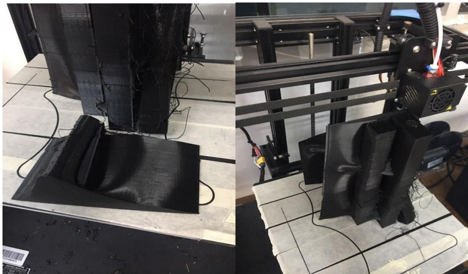
Kendala pada proses segmentasi 3 part menggunakan support di mesin 3D print Creality Ender 6
