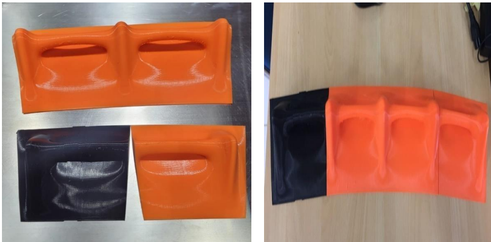
Segmentasi 1:1 pada mesin 3D print Creality Ender 6
