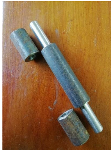
Gambar 4- 53 Besi assental yang sudah dilakukan pembubutan
