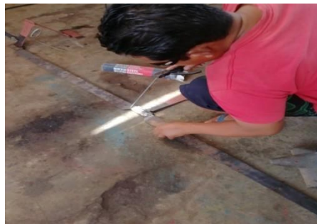
Gambar 4- 55 Proses pengelasan engsel dengan plat besi
