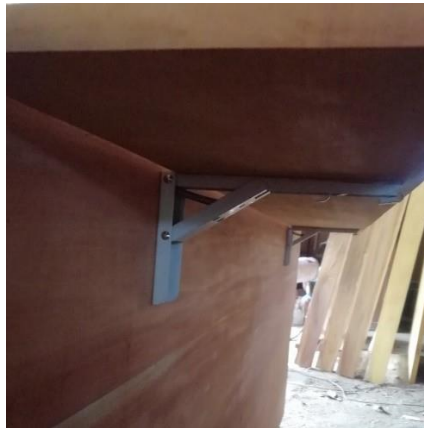
Gambar 4- 39 Hasil pemasangan engsel meja lipat
