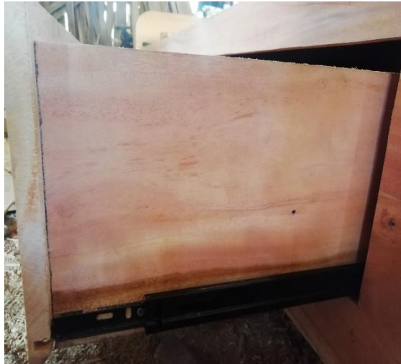
Gambar 4- 36 Rel sliding terpasang pada laci
