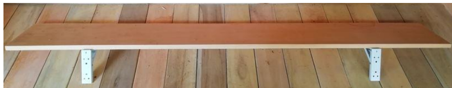
Gambar 4- 38 Engsel meja lipat terpasang pada papan kayu
