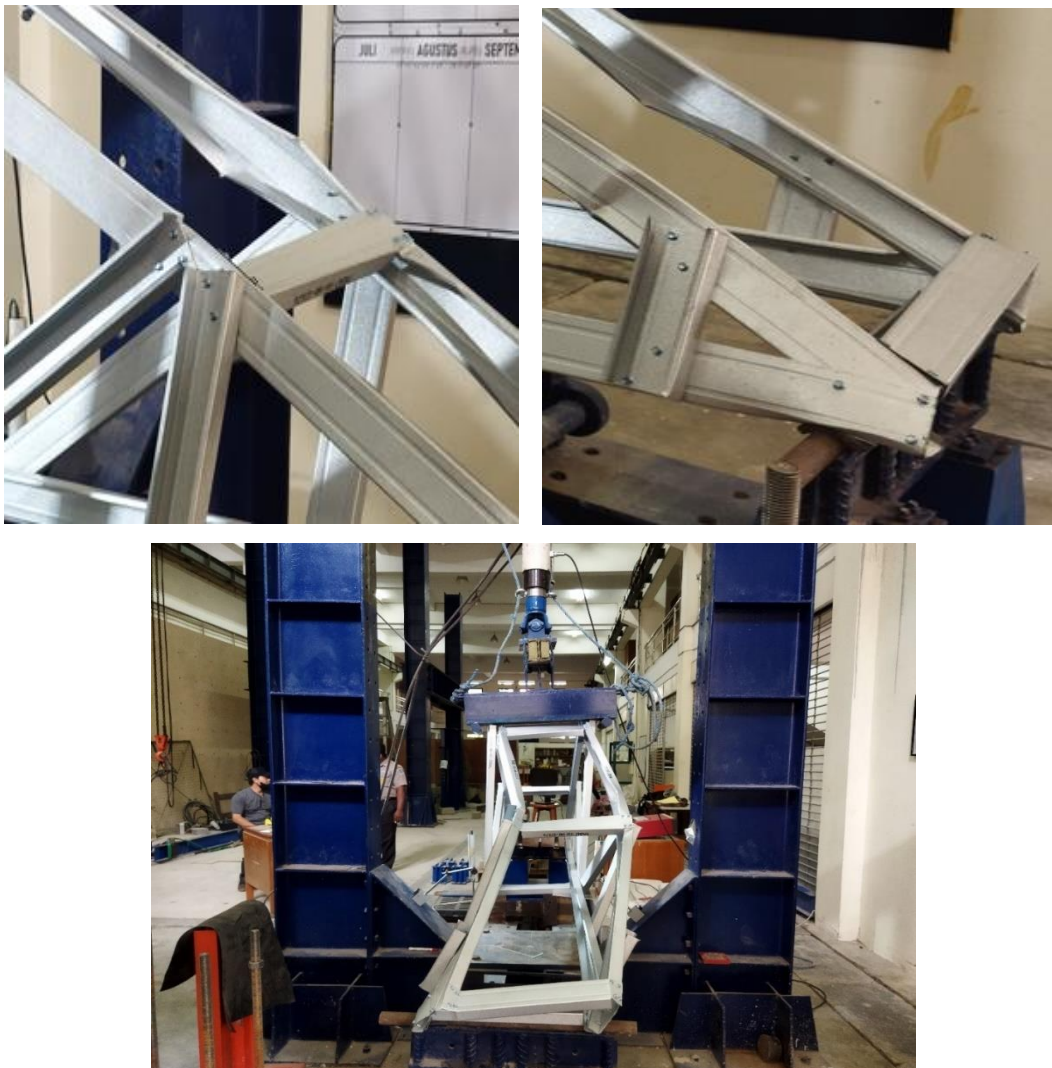
Gambar 5.12 Kegagalan Pada Struktur Rangka Profil Single Canal
