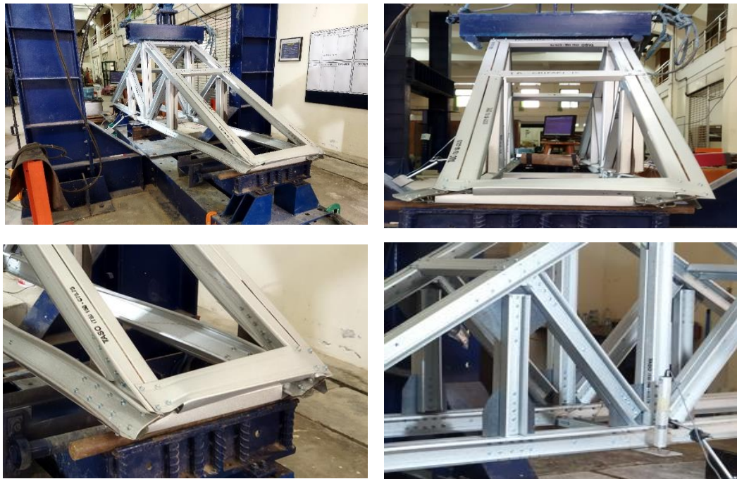
Gambar 5.16 Kegagalan Pada Tumpuan Pada Struktur Rangka Double Canal Back to Back
