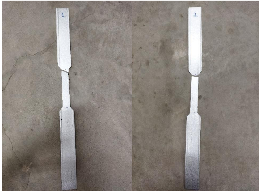
Gambar 5.1 Kerusakan Pada Sampel Baja C75 x 0,75 mm Setelah Diuji Tarik
