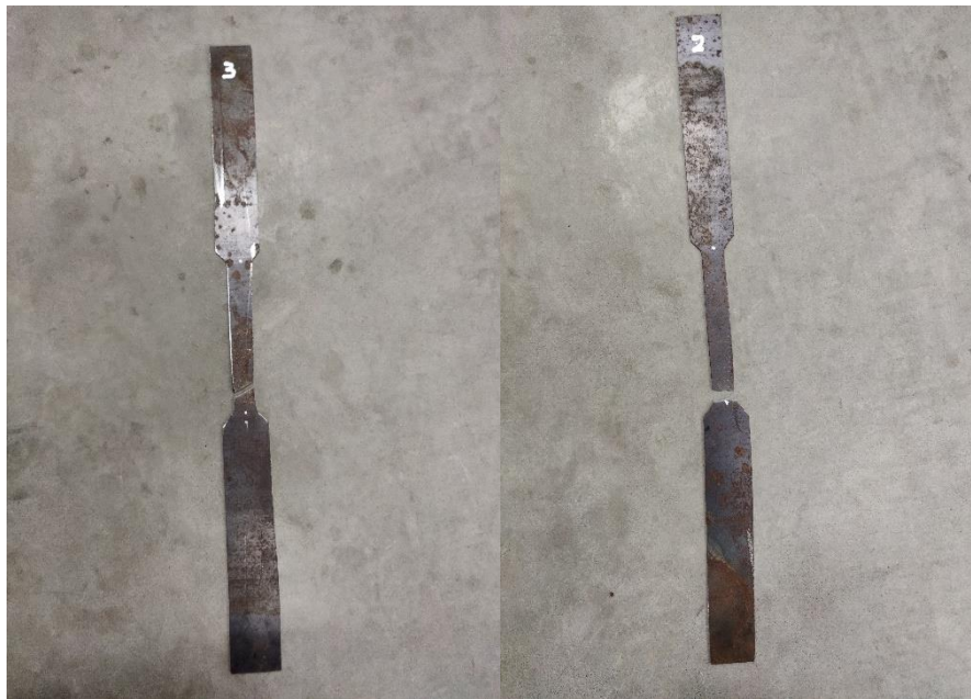
Gambar 5.3 Kerusakan Pada Sampel Baja 1,5 mm Setelah Diuji Tarik
