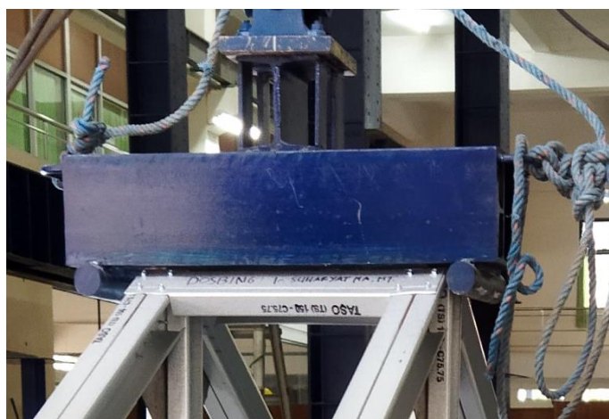
Gambar 5.15 Baja Pendistribusi Beban Pada Pengujian Rangka Double Canal Back to Back
