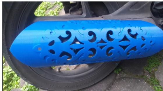
Gambar 4. 28 Pemasangan Cover Knalpot pada motor
