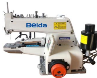
Gambar 3.14 Mesin Jahit Beida BD – 373
