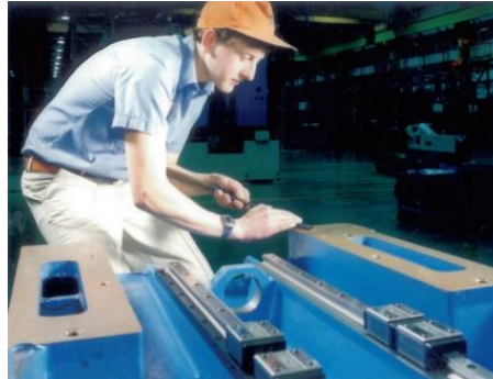
Gambar 2-1 hand scraping di Yamazaki Mazak Corporation
