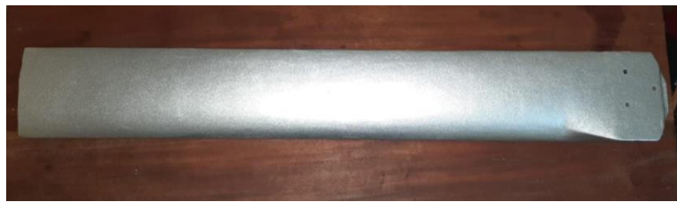
Gambar 4.6 Hasil Finishing Bilah Komposit
