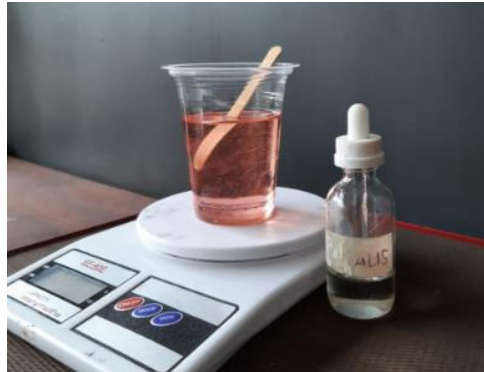
Gambar 3.23 Pencampuran Resin Dan Katalis
