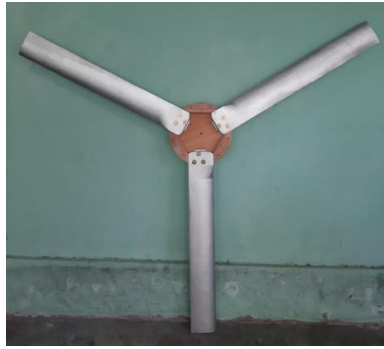
Gambar 4.7 Bilah setelah di assembly
