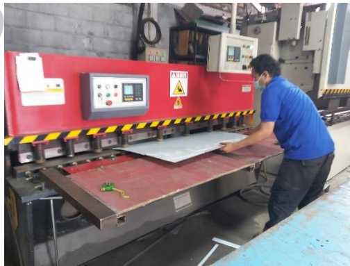
Gambar 3. 2 Pemotongan Spesimen dengan Metal Shearing Machine
