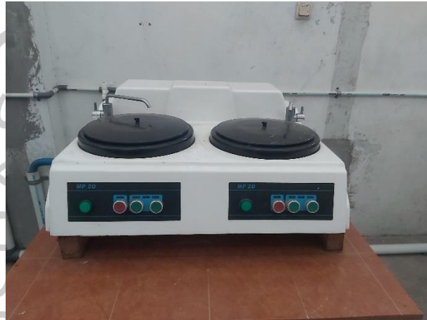
Gambar 3. 11 Mesin Gerinda Poles Mopao 2D (Laboratorium Bahan Teknik SV UGM)
