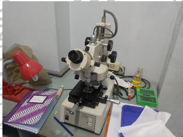
Gambar 3. 10 Alat Uji Mikro Vickers HMV V3 (Laboratorium Bahan Teknik SV UGM)
