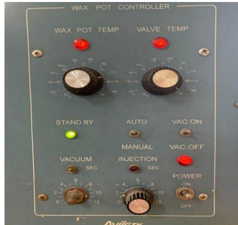
Gambar 3. 9 Pengaturan Wax Pot Temp dan Valve Temp
