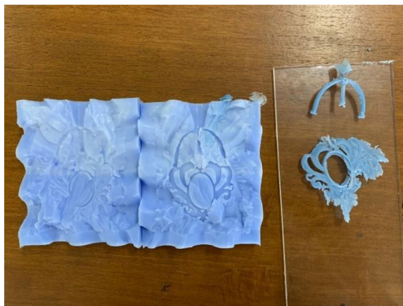
Gambar 4. 16 Hasil Pemotongan yang tidak rapi
