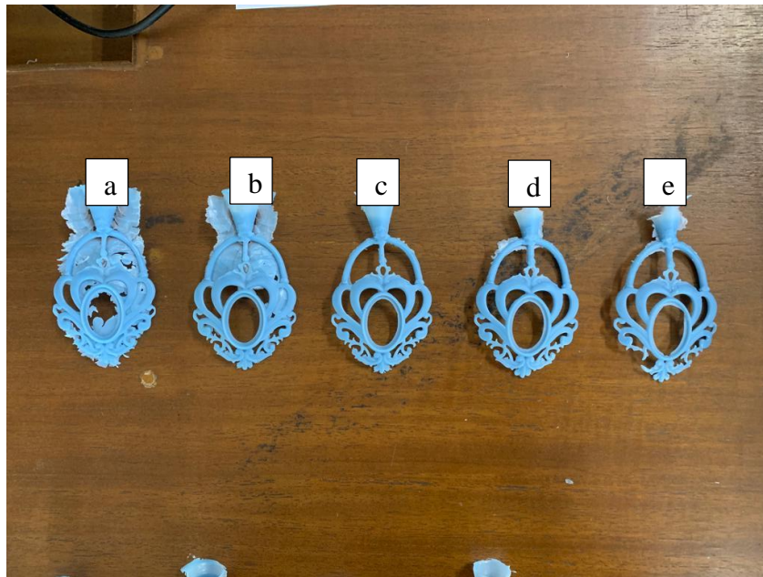
Gambar 4. 20 Hasil dengan tekanan (a)60MPa, (b)55 MPa, (c)50 MPa, (d)45 MPa dan (e)40MPa dengan waktu inject 7 detik
