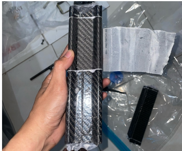
Gambar 3 - 15 Proses Pelepasan Polyester peel ply dan kain Breather
