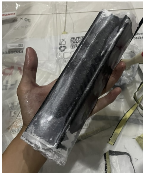
Gambar 3 - 13 Pelapisan Polyester Peel Ply dan Kain Breather
