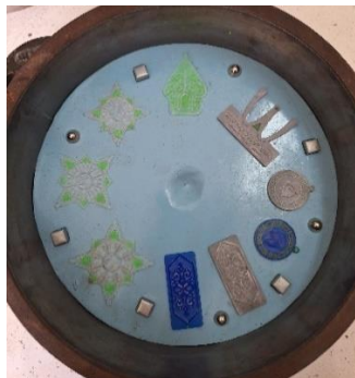
Gambar 3- 23 Menutupi Lubang pada Master dengan Rubber Elastis
