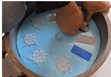
Gambar 3- 22 Penataan Posisi Master dan Penekanan Master
