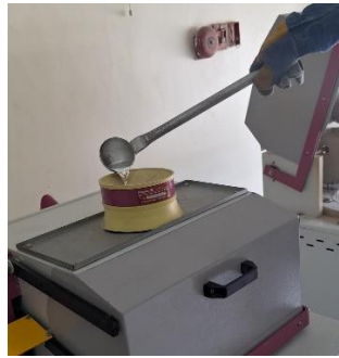
Gambar 3- 31 Proses Penuangan Zinc ke Mesin Spin Casting
