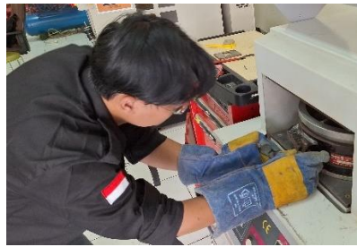
Gambar 3- 28 Proses memasukkan molding frame ke mesin vulkanisir
