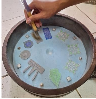
Gambar 3- 24 Memasang Pin dan Memberi Talc pada Permukaan Rubber
