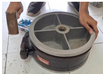
Gambar 3- 27 Menutup Rubber dan Mengunci Molding Frame
