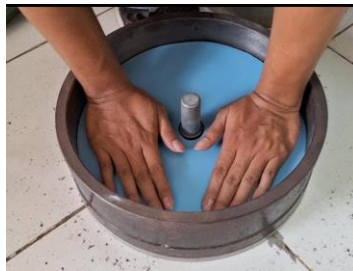
Gambar 3- 25 Pemasangan Rubber Mold bagian atas
