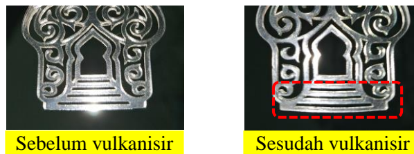
Gambar 4- 6 Kondisi Master Cetakan gunung setelah Vulkanisir
