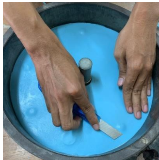
Gambar 3- 26 Proses Sayat Tonjolan Pin Pengunci
