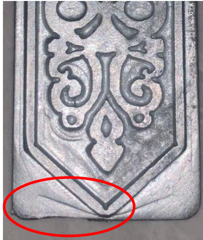
Gambar 4. 31 Hasil produk Talawang 800 rpm CW Akrilik
