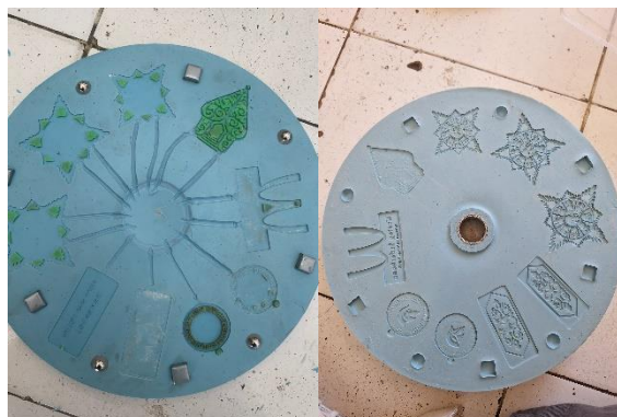
Gambar 4. 14 Cetakan hasil proses vulkanisir
