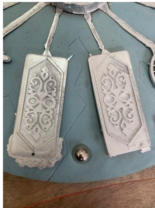
Gambar 4. 25 Hasil produk Spin Casting dengan kecepatan putar 850 rpm
