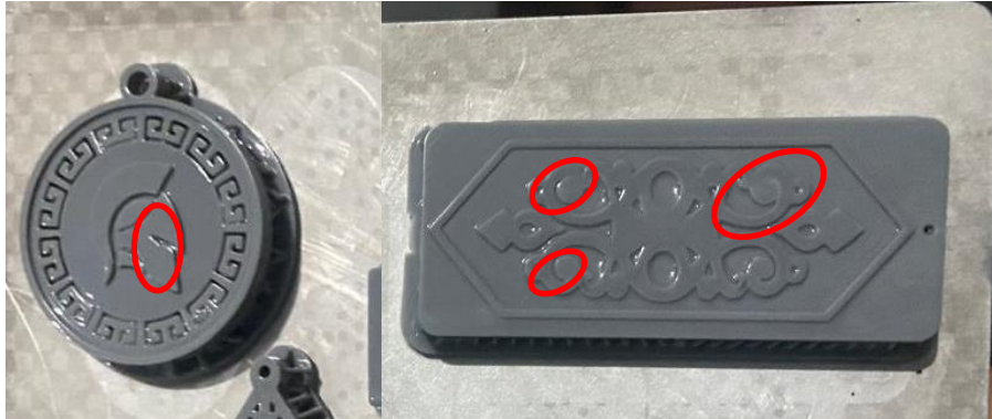
Gambar 4. 7 Master resin mengalami kecacatan
