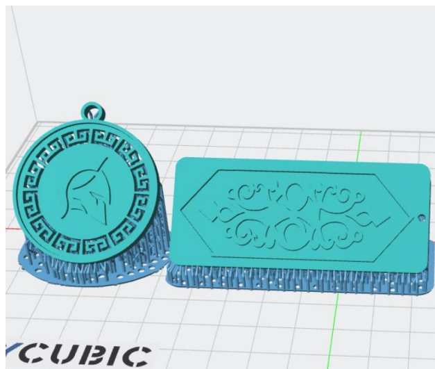
Gambar 4. 6 Master setelah ditambahkan support
