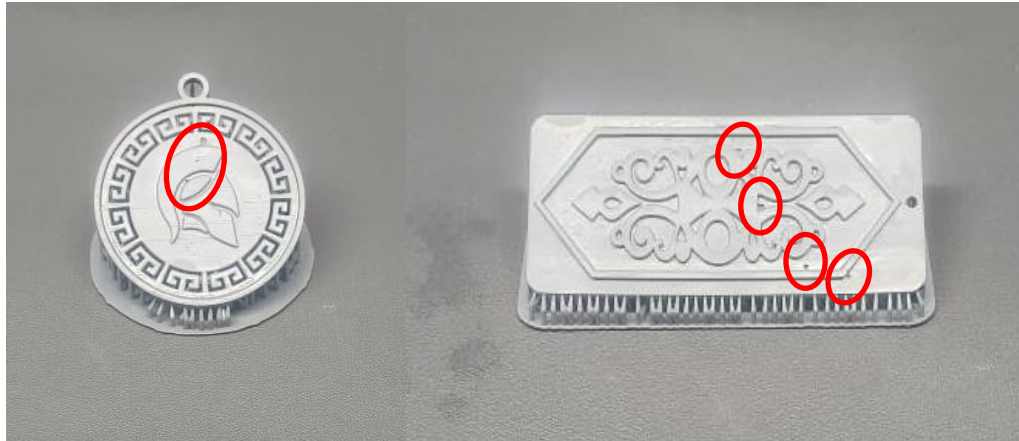
Gambar 4. 9 Cacat pada master resin
