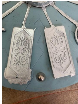
Gambar 4. 20 Keterisian logam melebihi cetakan
