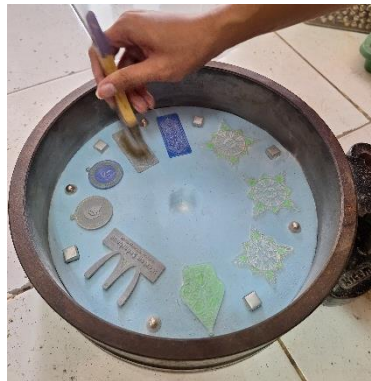
Gambar 4. 13 Pengolesan Talc pada silicone rubber mold
