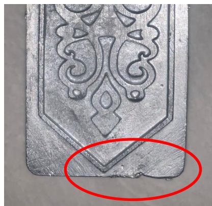
Gambar 4. 30 Hasil produk Talawang 700 rpm CW 3D Print Resin
