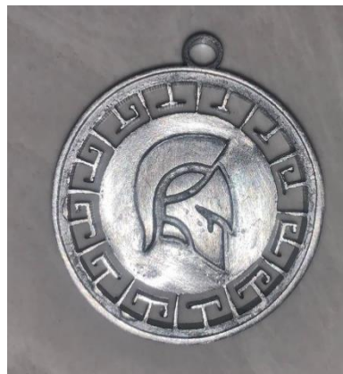
Gambar 4. 32 Hasil produk Spartan Warrior Akrilik tidak terisi sempurna
