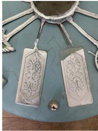
Gambar 4. 19 Produk tidak terisi sempurna
