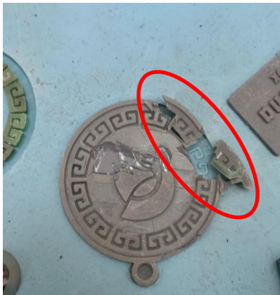
Gambar 4. 33 Produk gagal pada proses cetak
