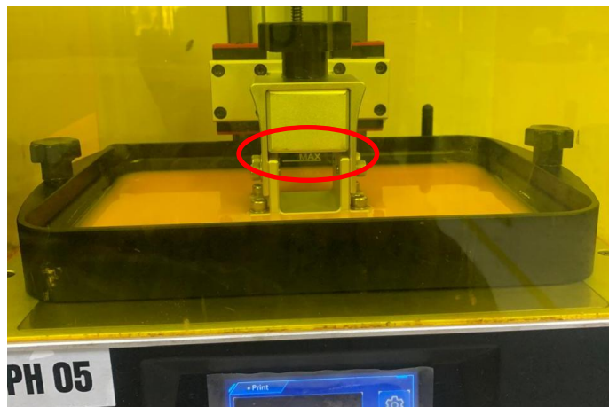
Gambar 4. 8 Garis batas max pada tank
