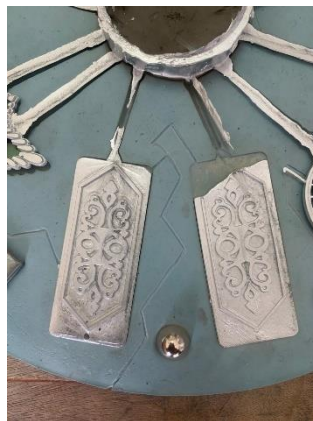
Gambar 4. 37 Produk tidak terisi dengan merata
