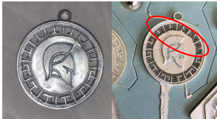
Gambar 4. 35 Produk tidak pernah terisi sempurna
