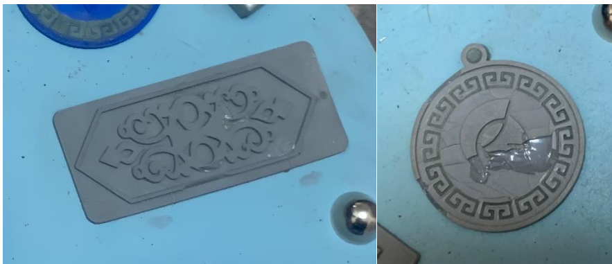
Gambar 4. 18 Kondisi Master 3D Print Resin setelah Vulkanisir
