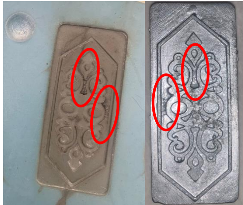
Gambar 4. 34 Cacat pada Rubber Mold
