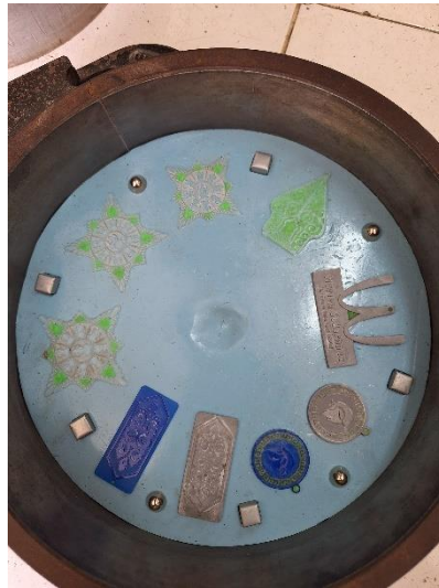
Gambar 4. 11 Penambahan plastisin pada master berlubang
