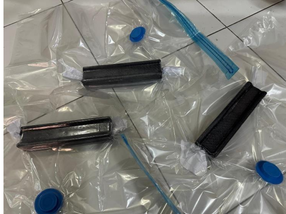
Gambar 3. 36 Memasukkan semua bahan kedalam vacuum bag
