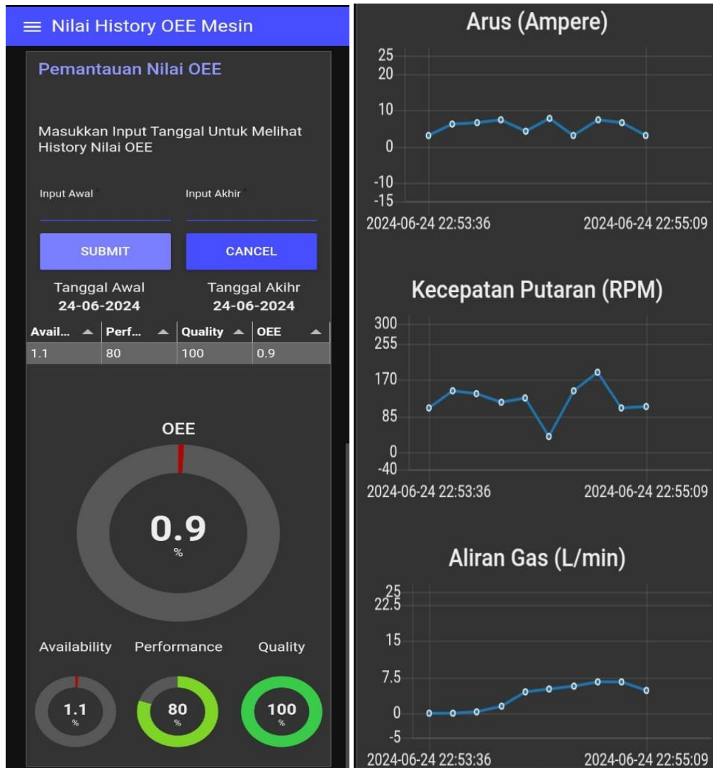
Gambar C-5 Hasil Perhitungan Nilai OEE Berdasarkan Modul Pengukuran pada Hari Ke-4
