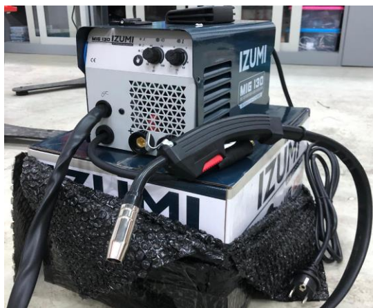
Gambar 3-2 Mesin Las Metal Inert Gas (MIG)
