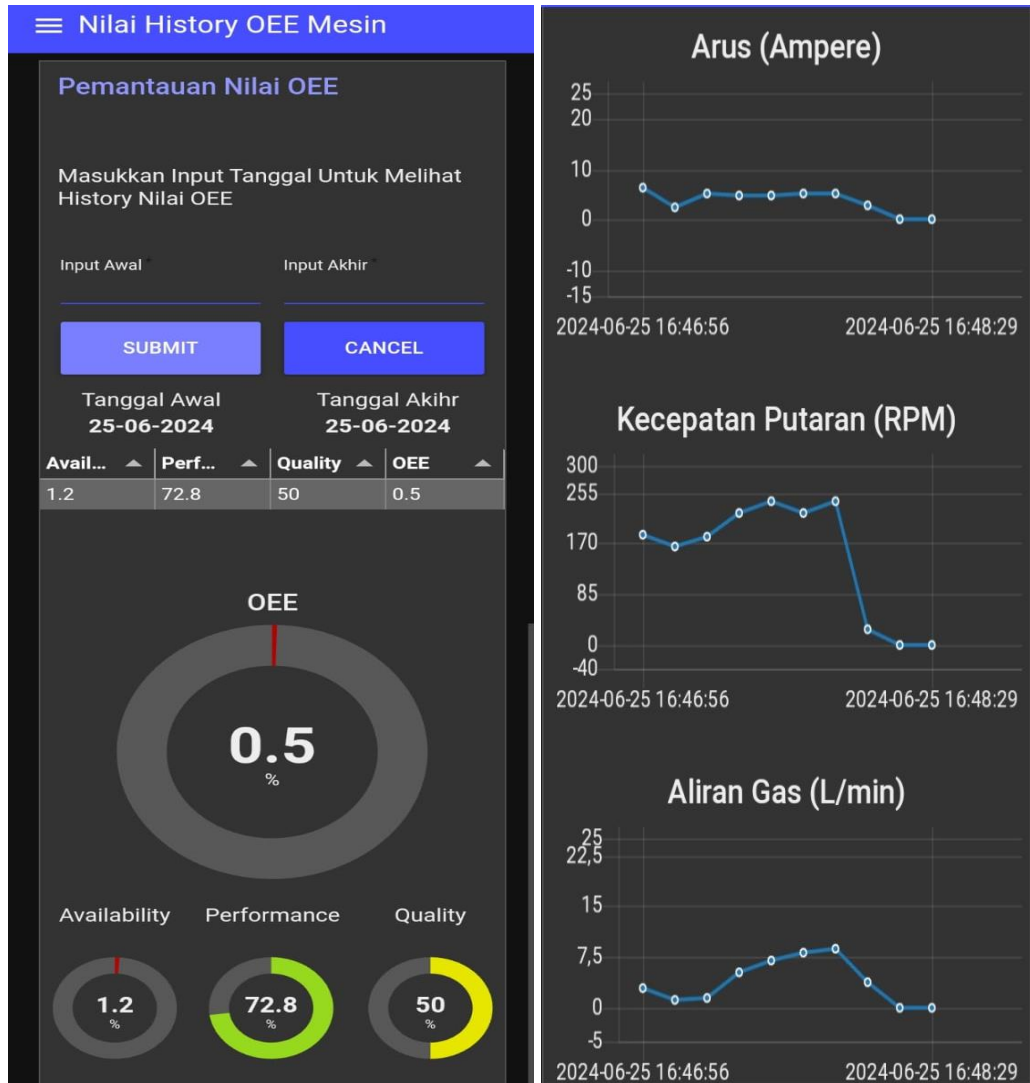
Gambar C-6 Hasil Perhitungan Nilai OEE Berdasarkan Modul Pengukuran pada Hari Ke-5
