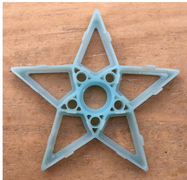
Gambar 4-4 Hasil 3D Print SLA Master Perhiasan Pertama
