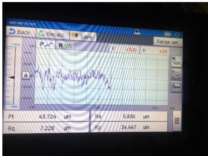
Gambar 4-22 Hasil Pengukuran Kekasaran Permukaan Gypsum Permesinan CNC Tanpa Vacuum
