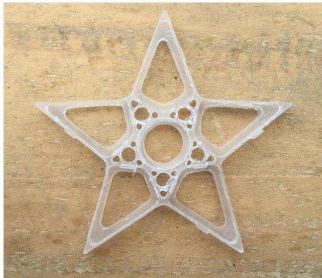
Gambar 4-2 Hasil Permesinan CNC Master Perhiasan Pertama
