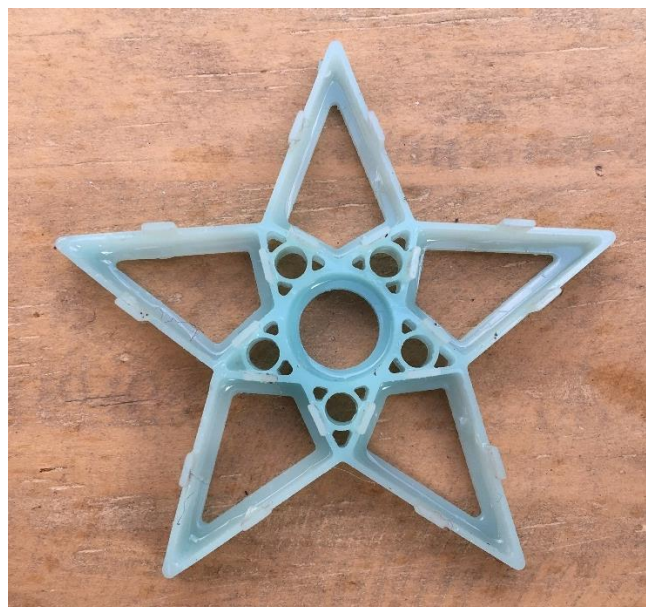
Gambar 4-5 Hasil 3D Print SLA Master Perhiasan Kedua
