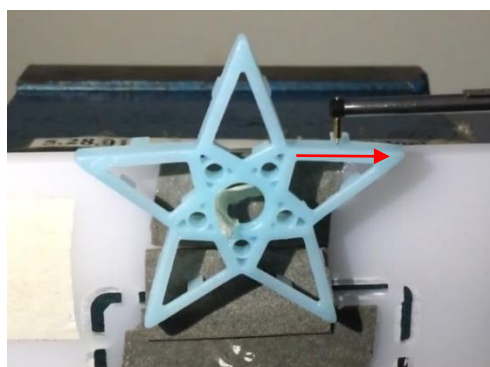
Gambar 4-15 Arah Ukur Titik Kedua Hasil 3D Print SLA
