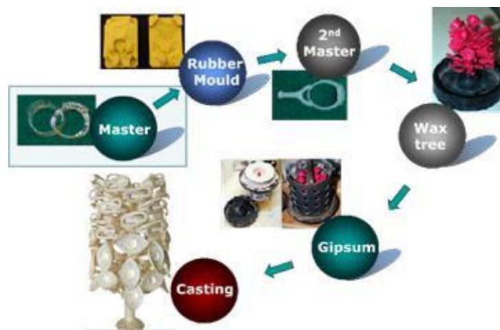
Gambar 2-1 Tahapan Pembuatan Perhiasan (Puspaputra, 2012)
