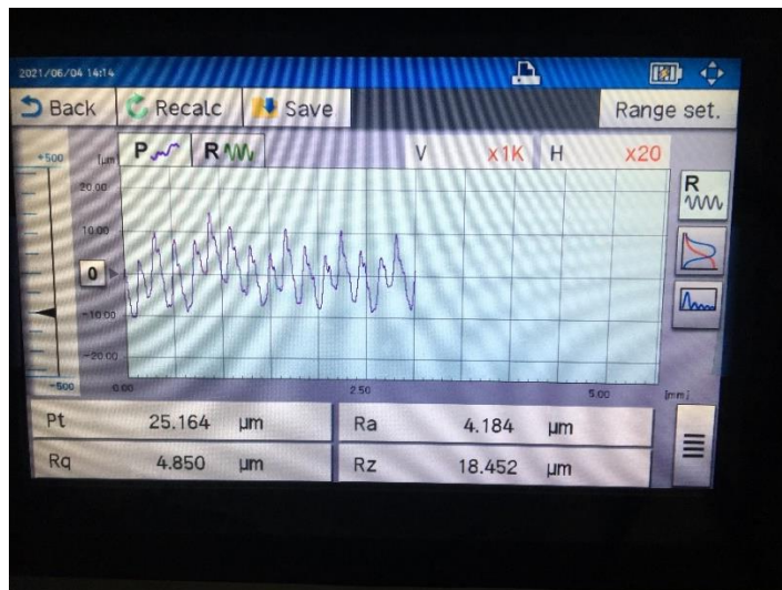
Gambar 4-19 Hasil Pengukuran Kekasaran Permukaan 3D Print SLA Master Perhiasan Kedua Titik Area Ukur Kedua
