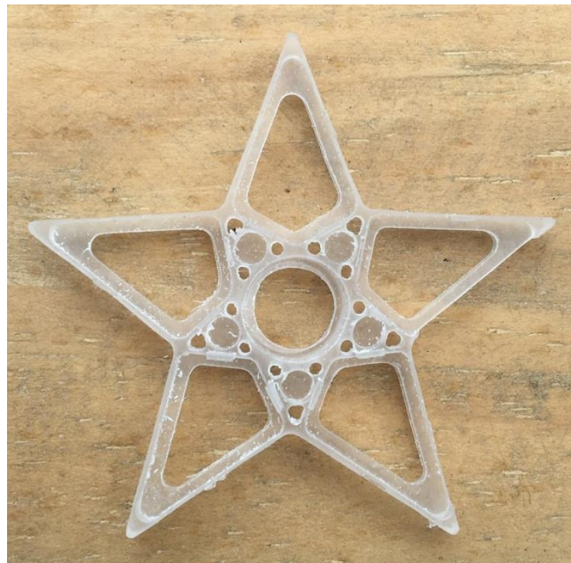
Gambar 4-3 Hasil Permesinan CNC Master Perhiasan Kedua
