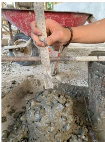
Gambar 5. 3 Pengujian Slump (Sumber: Dokumentas Pribadi)
