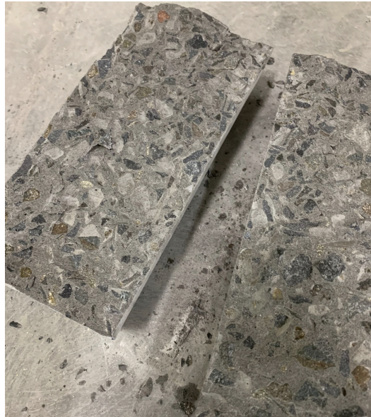
Gambar L.3.7 Benda Uji Setelah Pengujian Kuat Tarik Belah
