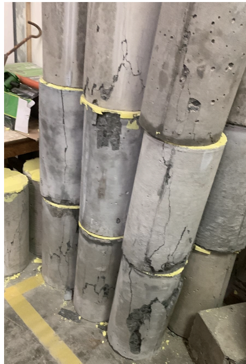
Gambar L.3.6 Benda Uji Setelah Pengujian Kuat Tekan
