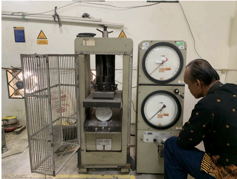
Gambar L.3.5 Proses Uji Kuat Tarik Belah
