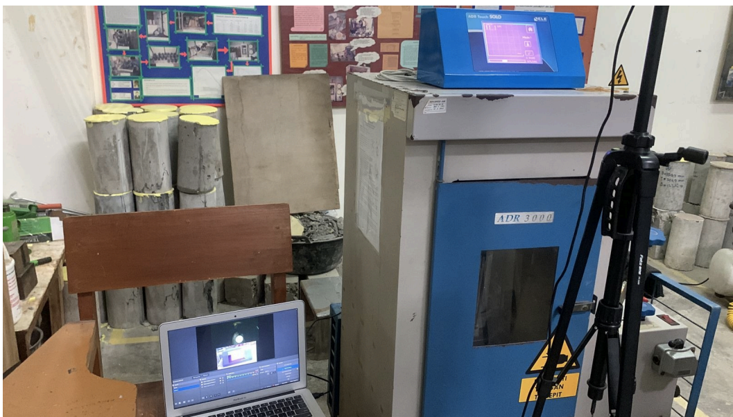
Gambar L.3.4 Proses Uji Kuat Tekan dan Modulus Elastisitas
