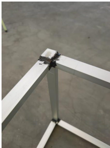
Gambar 4.5.1-4 corner fitting yang telah tempelkan
