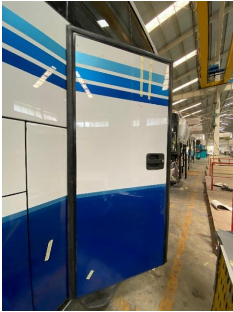
Gambar 4. 20 Pintu Belakang (Luar) Legacy SR 3 HD Prime Model Swing Door Sumber: PT. Laksana Bus Manufaktur
