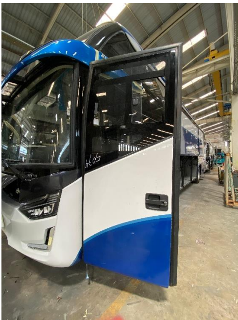
Gambar 4. 18 Pintu Depan (Luar) Legacy SR 3 HD Prime Model Swing Door Sumber: PT. Laksana Bus Manufaktur
