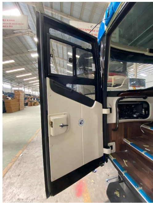
Gambar 4. 19 Pintu Depan (Dalam) Legacy SR 3 HD Prime Model Swing Door Sumber: PT. Laksana Bus Manufaktur
