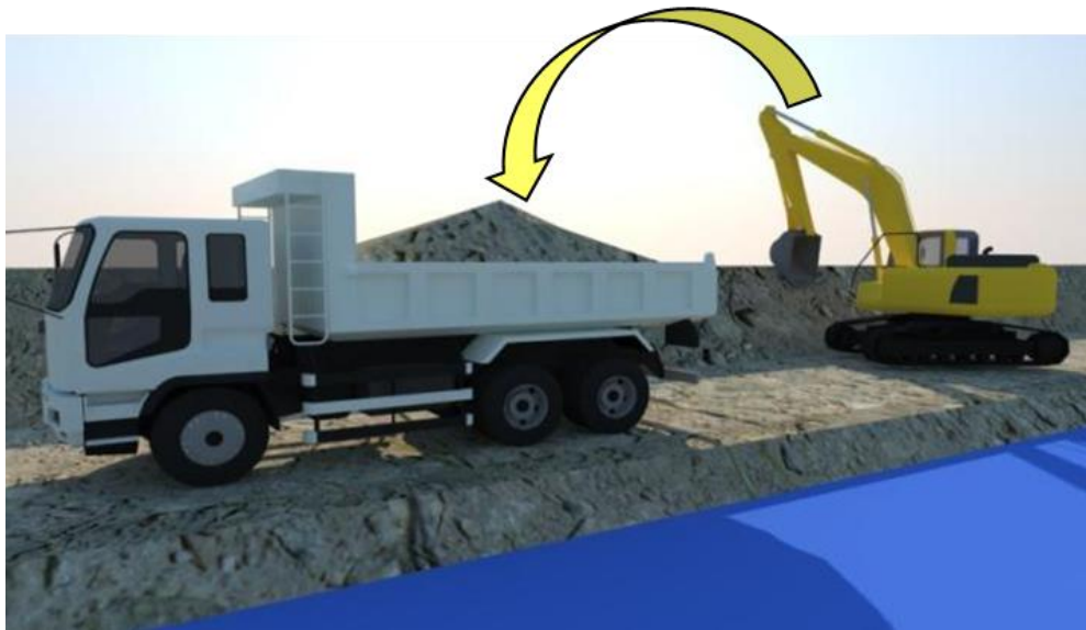
Gambar 5. 22 Ilustrasi Pengangkutan Tanah Hasil Galian Menuju Disposal Area
