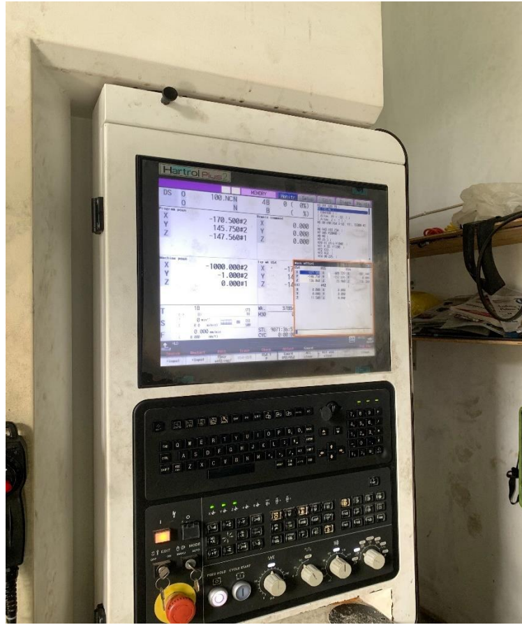
Gambar 4-14 Pengaturan offset pada mesin CNC
