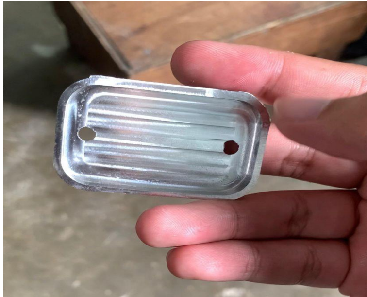
Gambar 4-24 Hasil pemesinan bagian bawah
