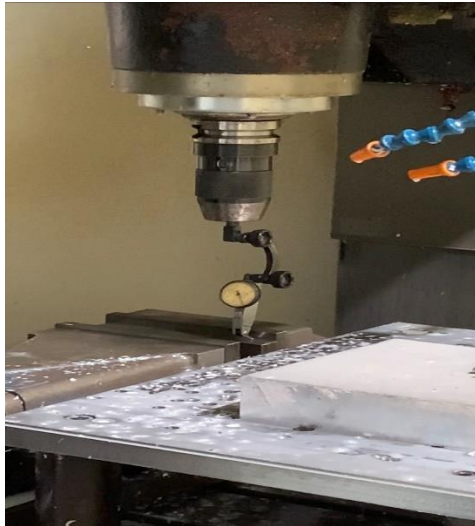
Gambar 4-10 Dual indicator mengatur kerataan bidang
