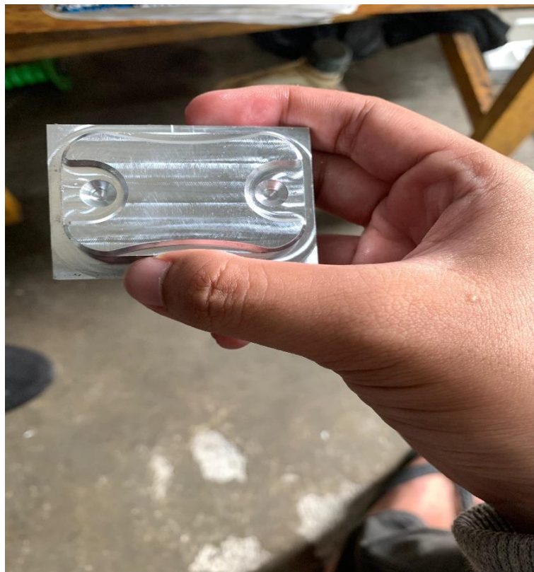
Gambar 4-20 Hasil pemesinan bagian atas
