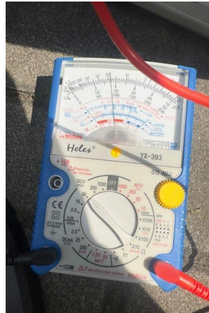
Melakukan Uji Coba PV dengan multimeter
