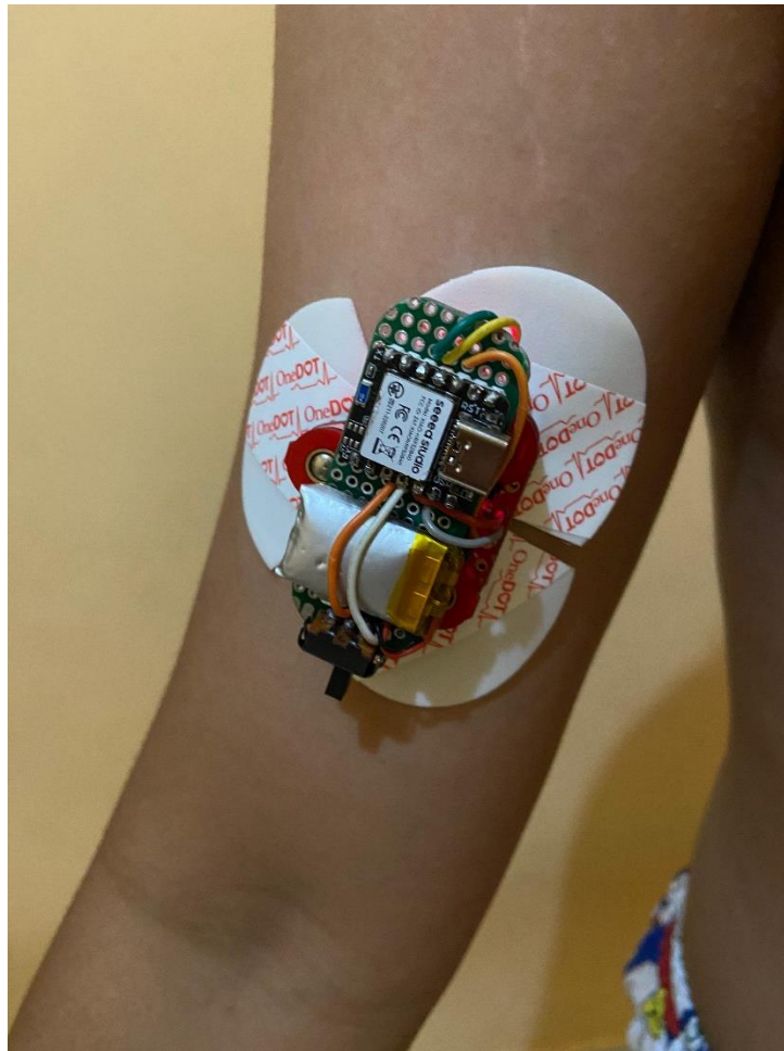
Gambar 5.2 Data sinyal otot variasi ke-1 posisi penempatan alat
