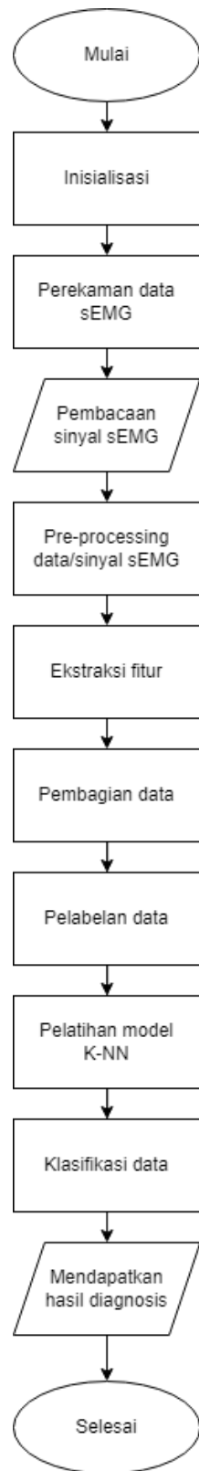
Gambar 3.6 Proses cara kerja sistem deteksi kelelahan otot menggunakan algoritma K-NN
