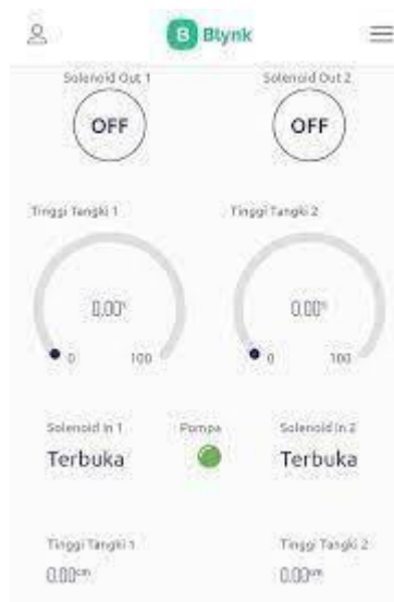
Gambar 3.7 Contoh antarmuka untuk kontrol solenoid
