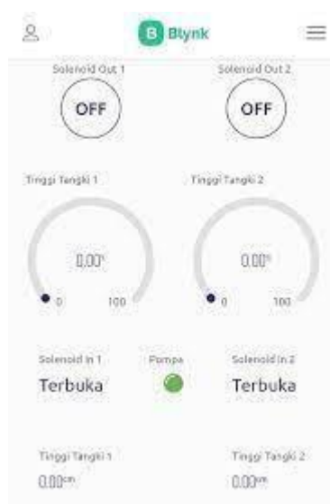
Gambar 3.4 Contoh antarmuka untuk kontrol solenoid
