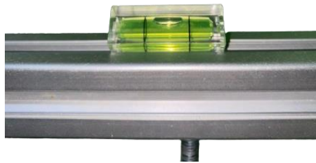
Gambar L-3.2 Penyetelan Posisi Balok menggunakan Water Pass
