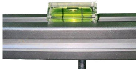
Gambar 5. 15 Penyetelan Posisi Balok menggunakan Water Pass
