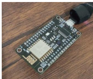
Gambar 3.7 Konfigurasi NodeMCU v3
