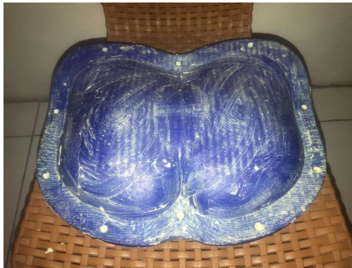
Gambar 4. 2 Cetakan untuk Produksi Bantalan yang Diolesi Sabun Colek
