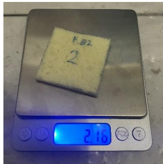
Gambar 4. 12 Sampel 2 Bantalan PUF Formula 4 saat Ditimbang untuk Mengetahui Massanya
