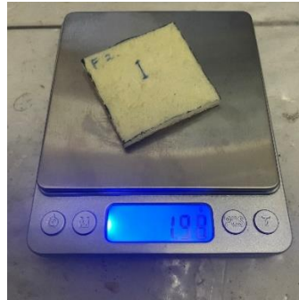
Gambar 4. 11 Sampel 1 Bantalan PUF Formula 4 saat Ditimbang untuk Mengetahui Massanya
