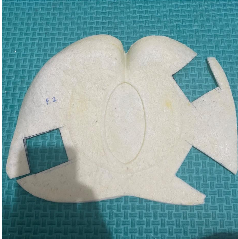
Gambar 4. 8 Bantalan PUF yang Berhasil Terbentuk Menggunakan Formula Polioliol 200 ml, Isosianat 98 ml, dan Air 2 ml.
