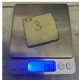
Gambar 4. 13 Sampel 3 Bantalan PUF Formula 4 saat Ditimbang untuk Mengetahui Massanya
