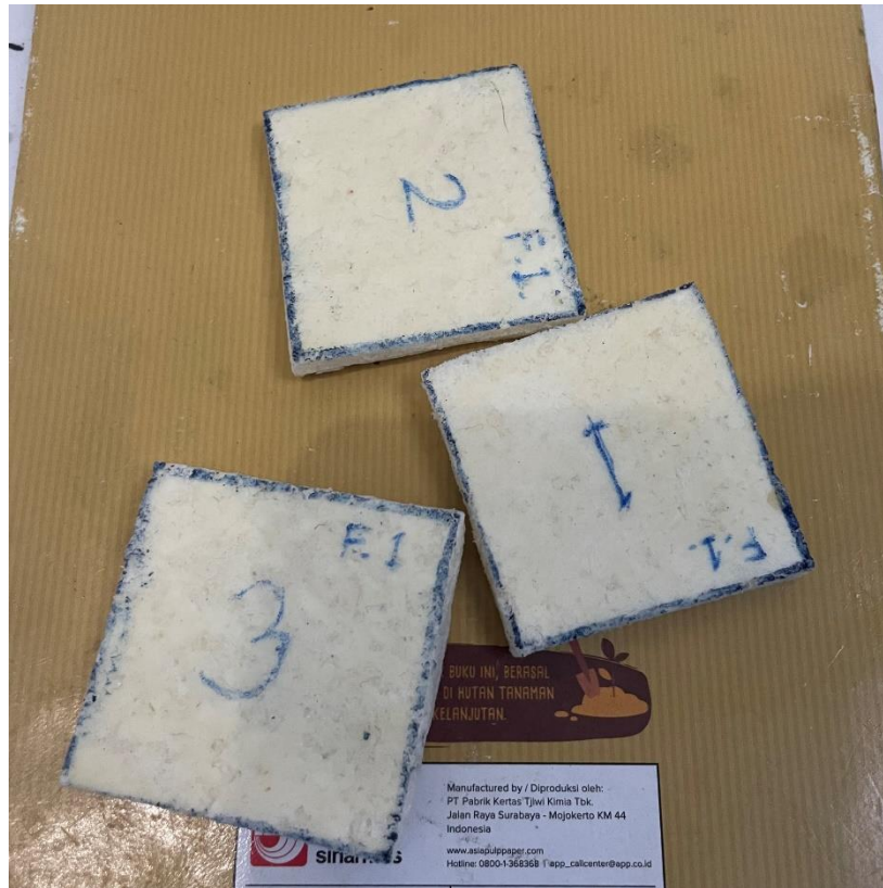
Gambar 4. 9 Sampel untuk Formula 3 Polioliol 173 ml, Isosianat 125 ml, dan Air 2 ml
