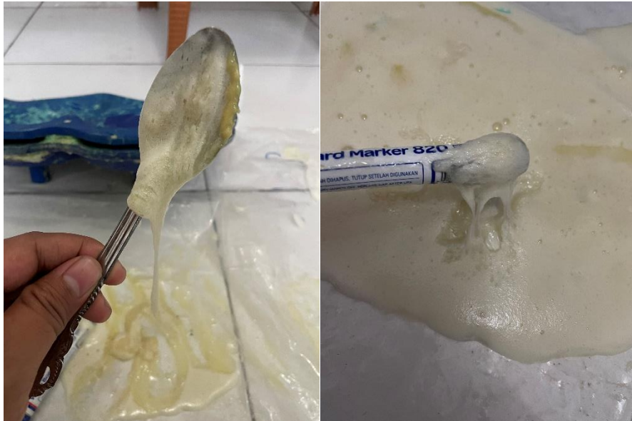
Gambar 4. 14 Tumpahan Formula Polioliol 250 ml, Isosianat 48 ml, dan Air 2 ml saat Mengembang seperti Adonan Kue
