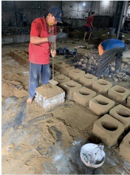
Gambar 4. 4. Proses Penumbukan Cetakan Supaya Padat.
