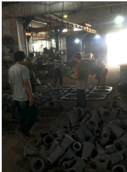
Gambar 4. 14. Proses Pemindahan Besi Coran ke Tempat Sortir.
