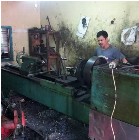
Gambar 4. 19. Proses Pemasangan Besi Coran Ke Mesin Bubut.
