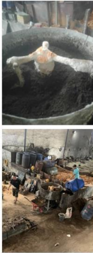
Gambar 4. 3. Proses Pencampuran semen dan tanah.
