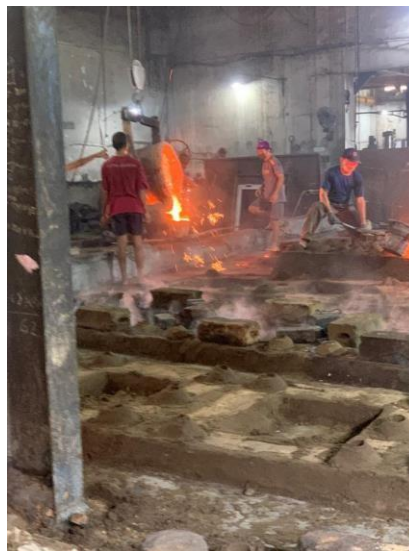
Gambar 4. 10. Proses Pengangkutan Tungku Oven dengan Crane.
