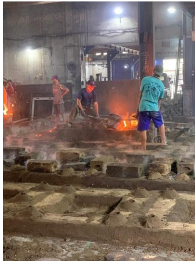
Gambar 4. 12. Proses Penuangan Cairan ke Dalam Cetakan.
