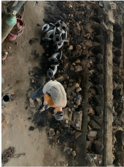
Gambar 4. 13. Memisahkan Besi Coran dari Pasir Cetakan.
