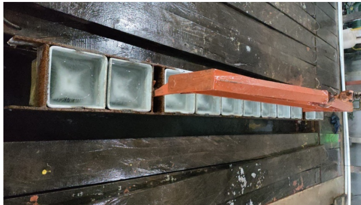
Gambar 4. 6 Proses Pengambilan Es Balok
