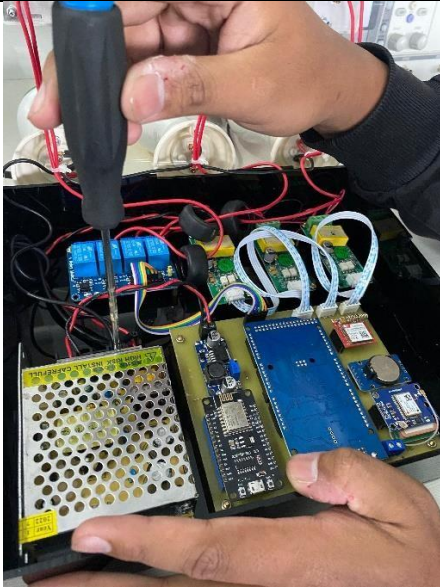
Lampiran 6 Pemasangan TrafficEase IoT ke wadah
