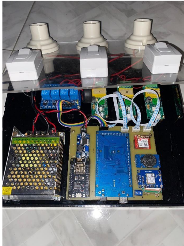
Gambar 4.7 Hasil perancangan Sistem TrafficEase IoT ketika tidak dialiri listrik
