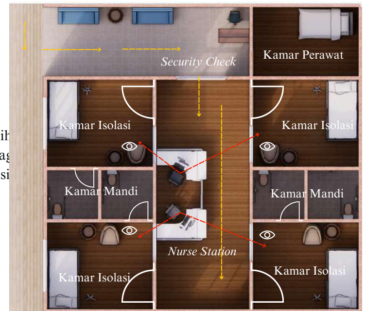
Gambar 5.16 Denah Ruang Isolasi Sumber : Penulis, 2024.
