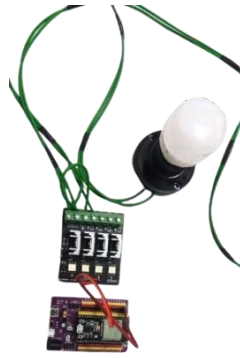
Gambar 3.26 Konfigurasi Board ESP32 dengan Dimmer
