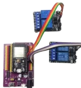
Gambar 3.25 Konfigurasi Board ESP32 dengan Relay
