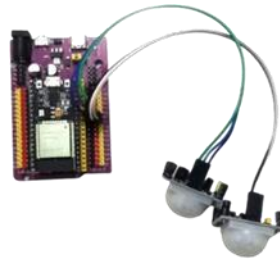
Gambar 3.24 Konfigurasi Board ESP32 dengan Sensor PIR
