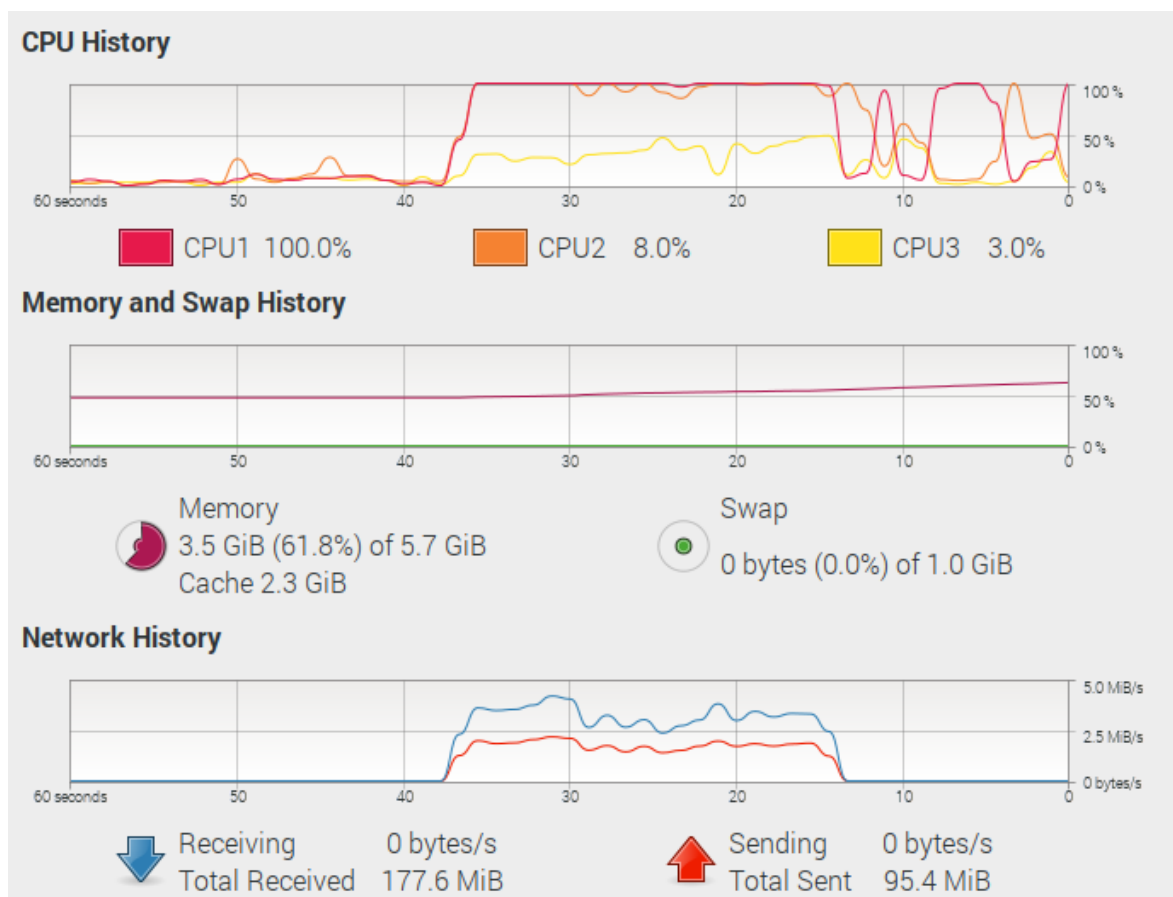
Gambar 4.44 Sistem monitor ketika pengujian SYN Flood Attack
