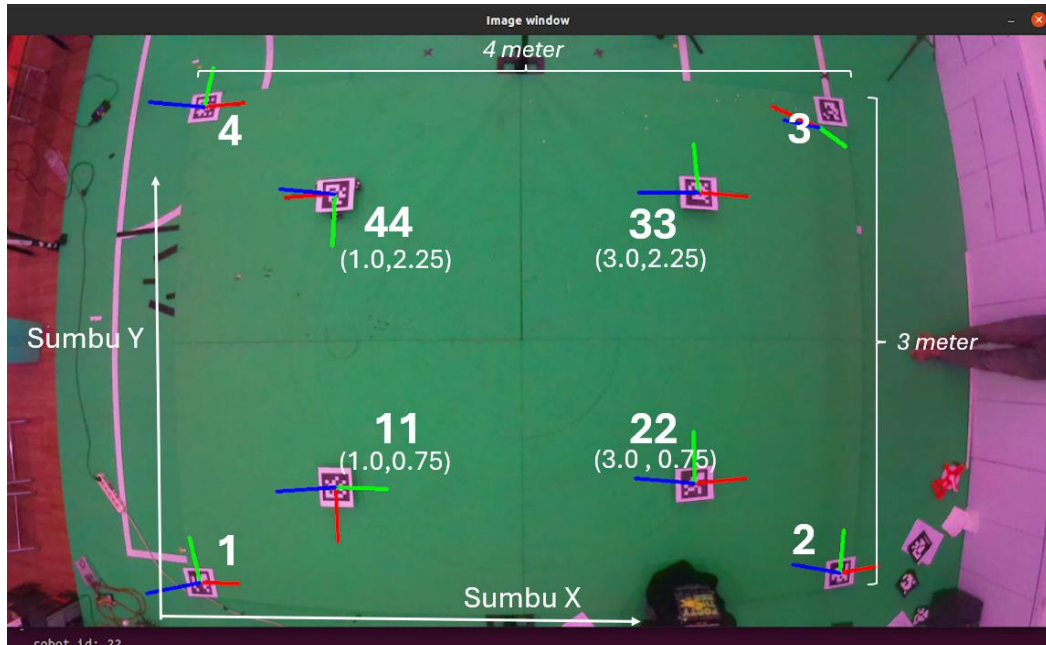
Gambar 5. 3 Pembacaan marker sudut lapangan dan marker robot pada lapangan berukuran 4 x 3 m
