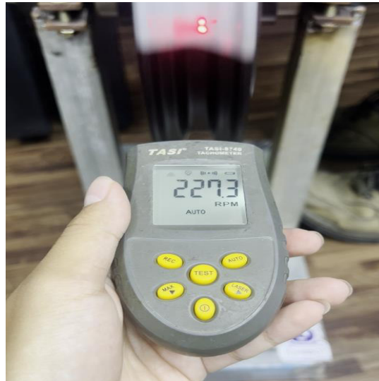
Gambar 4.6 Pengukuran RPM menggunakan Tachometer infrared
