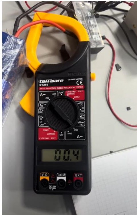
Gambar 4.7 Pengukuran arus sistem Minicont-EV menggunakan Multiimeter Clamp
