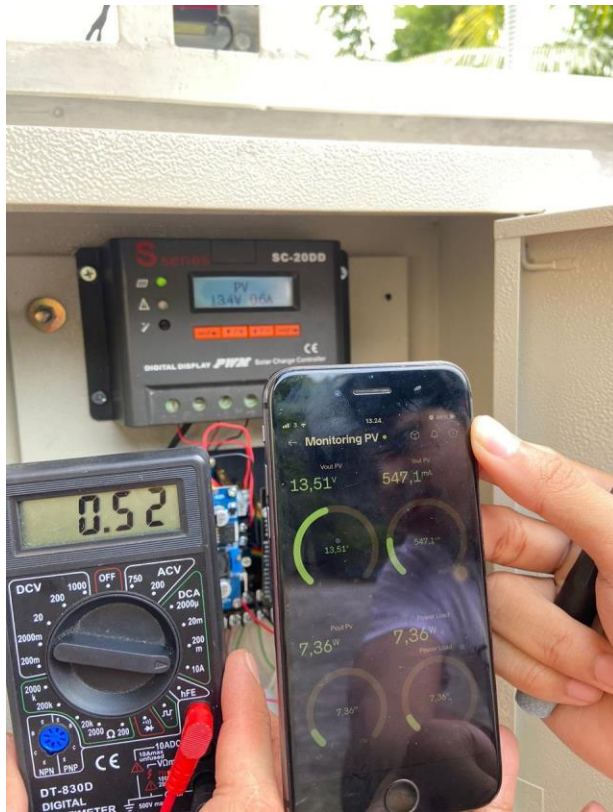
Gambar 5.4 Pengujian terhadap keluaran panel surya
