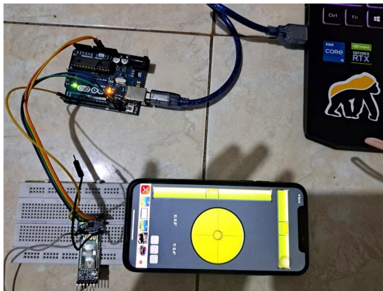
Gambar 5. 2 Proses kalibrasi dengan acuan aplikasi “Laser Level”
