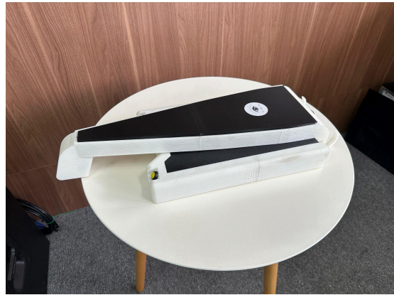
Gambar 4.12. Tampak jadi alat pemindai teks portable
