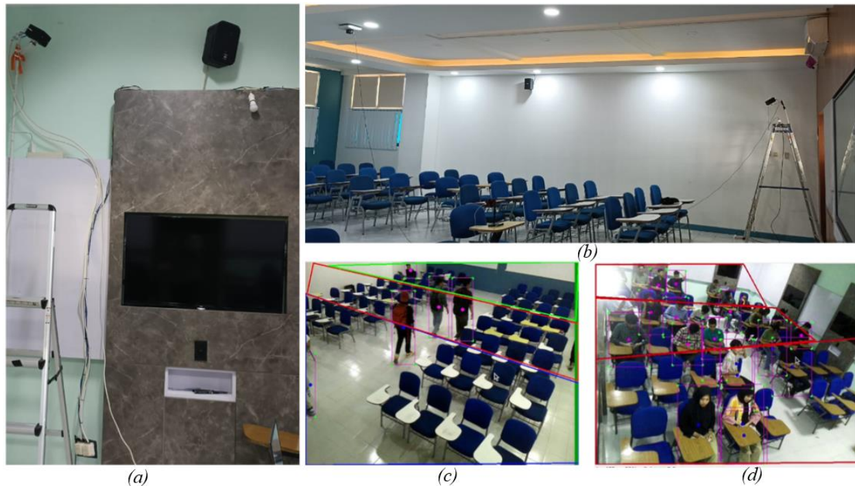
Gambar 4.7.a Visualisasi sistem utama dan saklar manual, b. Setup sistem utama dan remote, c. Pembagian ROI pada frame deteksi di ruang kelas besar, d. Pembagian ROI pada frame deteksi di ruang kelas kecil
