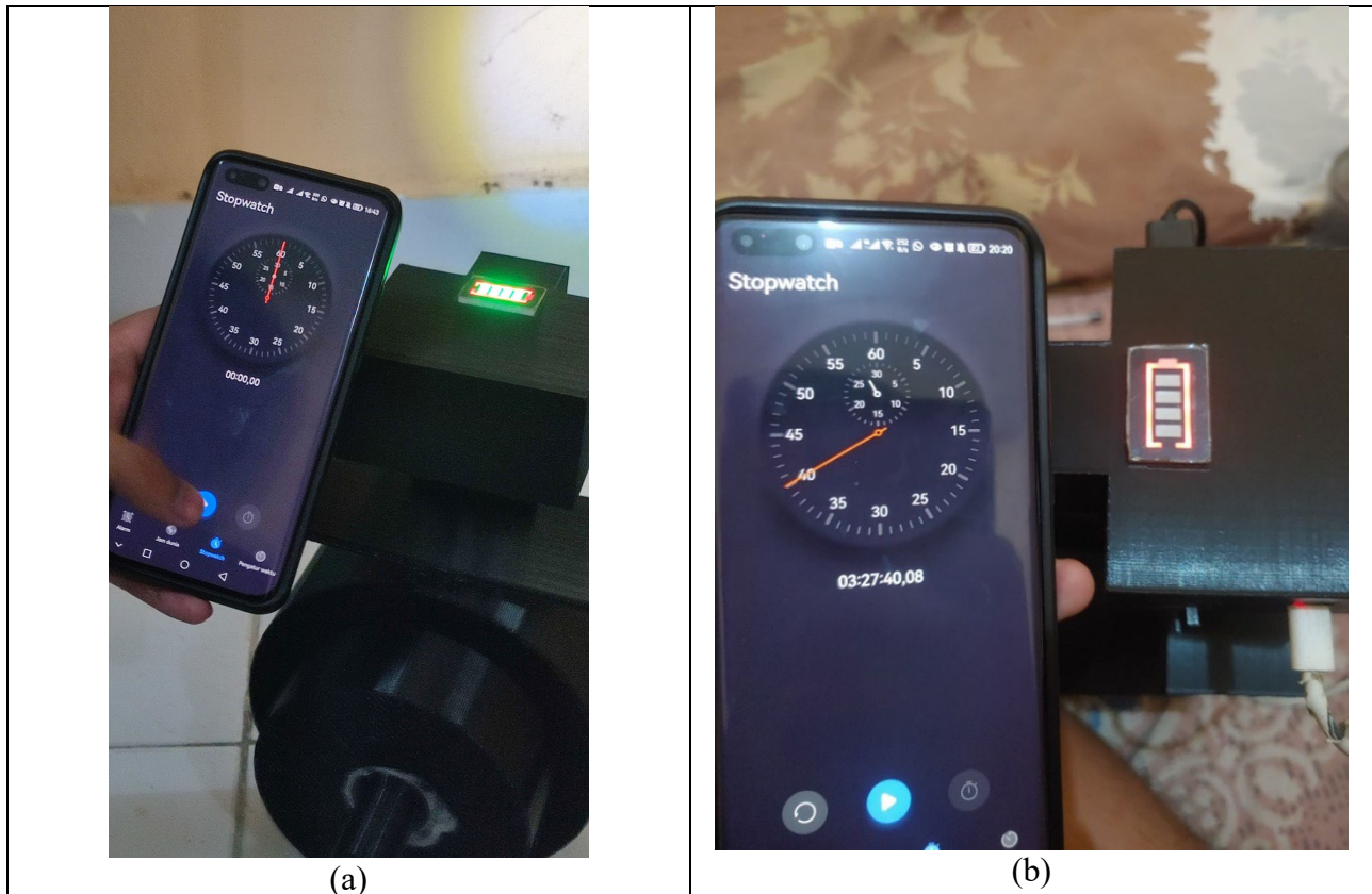
Gambar 5.5 (a) awal pengujian charge baterai kamera, (b) akhir pengujian charge baterai kamera
